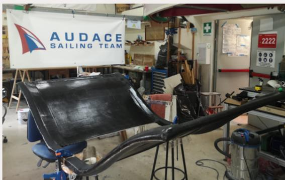
Le terrazze sono state completamente assemblate e verniciate, passando finalmente da un insieme di pezzi sparsi a una struttura unitaria e definita. Nonostante alcune criticità riscontrate nella finitura estetica e aerodinamica delle terrazze, il team è riuscito a risolverle con successo.
