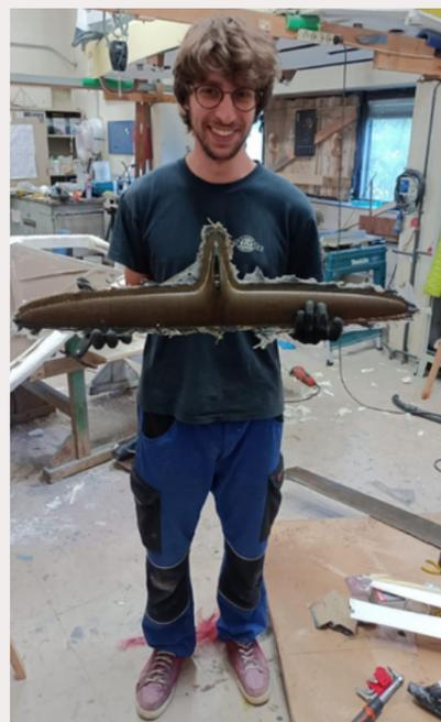
Sono stati inoltre realizzati vari set di derive e timoni in carbonio e lino. Il primo set di ricambio ha presentato un problema con la canalina di controllo del flap, che si è intasata. Fortunatamente, questo problema è stato risolto nei successivi set, utilizzando colla a caldo per prevenire questo tipo di problematiche.
